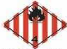
N°4.1 Danger de feu (matière solide inflammable)
